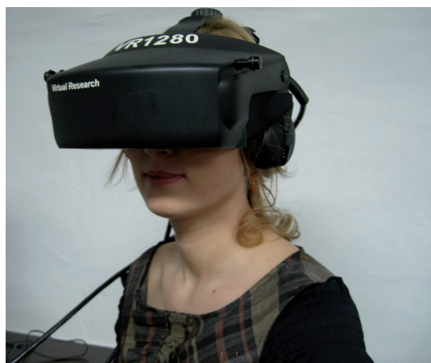
Figura 1. Imaginea unui dispozitiv de tip cască, pentru vizualizarea unui mediu virtual 3D.
